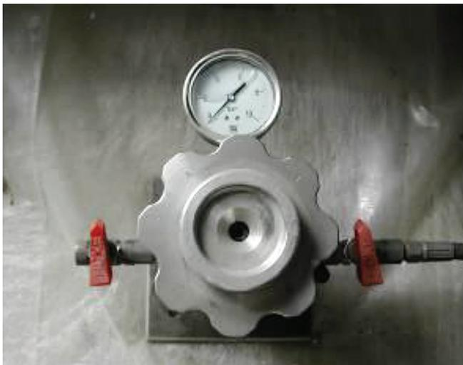
Figura 1: Cámara de medida de potencial hídrico foliar.
