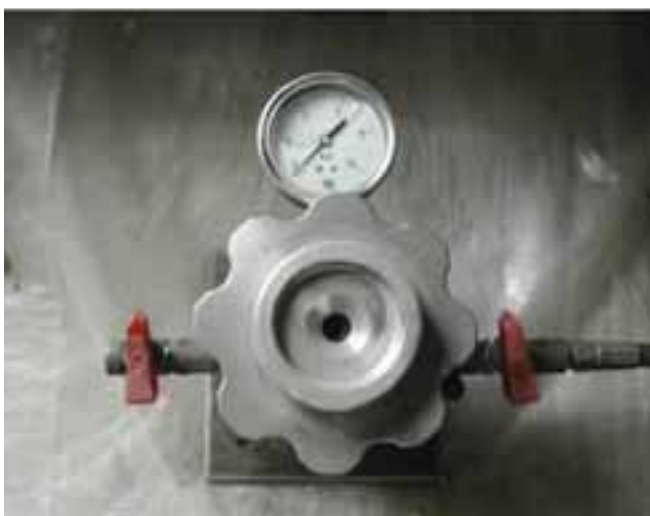
Figura 1: Cámara de medida de potencial hídrico foliar.
